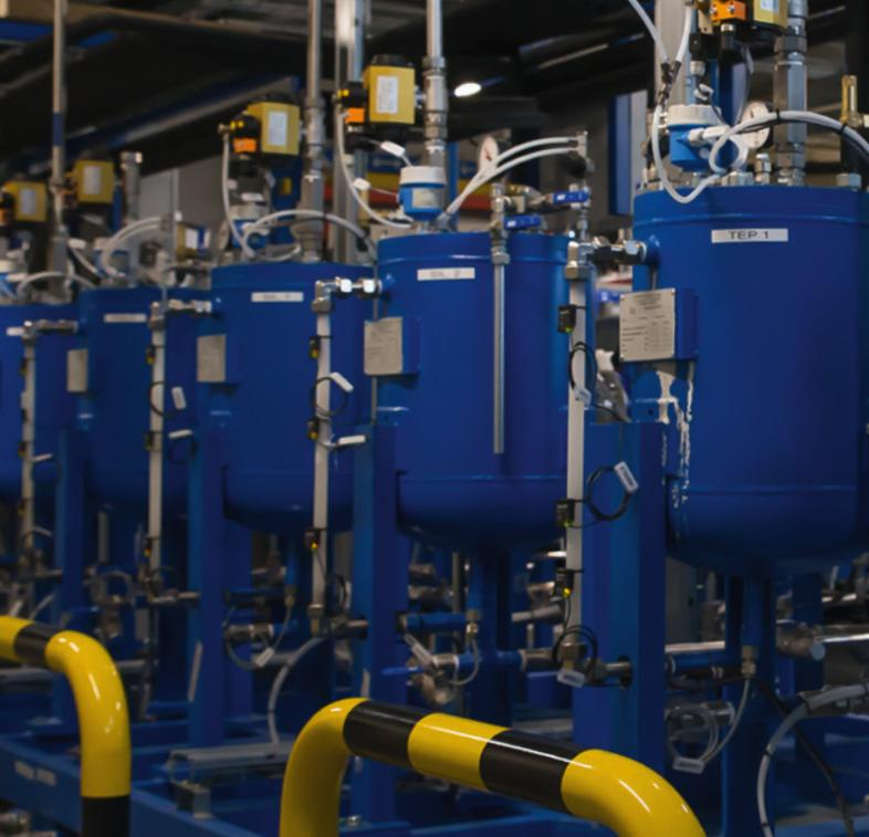
12 pompes permettent de mélanger précisément chacun des éléments de la recette du swissporPUR (PIR)
